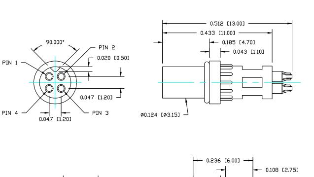
M5 FEMALE - CABLE MOUNT - SOLDER CUP - 4 POSITION
